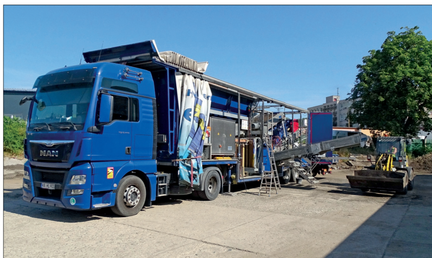
Mobilní třídící dovezený výrobcem na skladovém dvoře přetřídil 300 tun připravených smetků na dvě frakce. V Litoměřicích uvažují do budoucna o pořízení vlastní technologie
